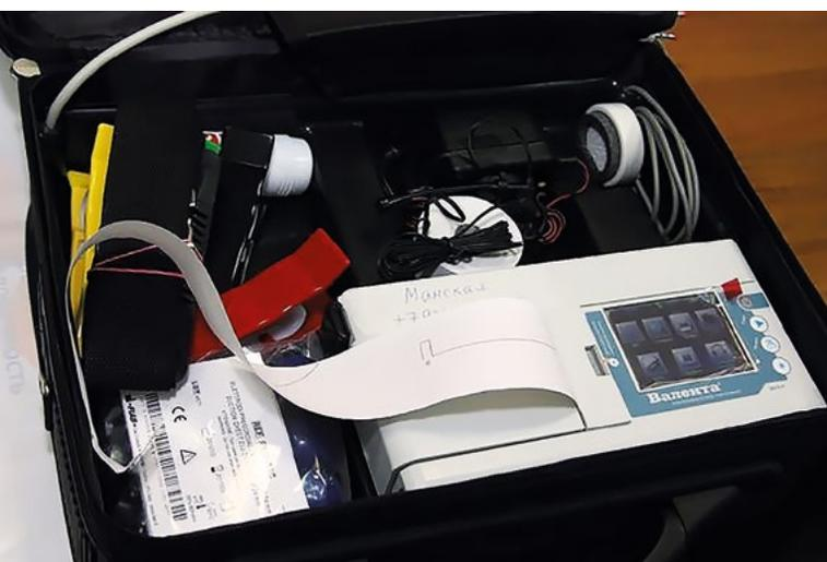
**Рис 1.** ЭКГ-аппарат с функцией дистанционной передачи данных (Валента)
